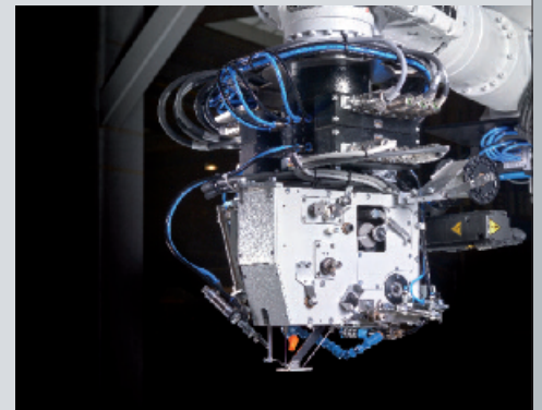
RS 530 Zweinadel: Einfaden-Kettenstich 2 needle: One thread chain stitch Dos agujas: Puntada de cadeneta de un solo hilo
